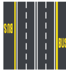
Striscia di delimitazione di corsia riservata
